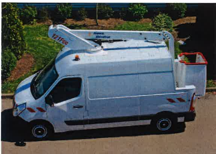
Montage sur porteur RENAULT MASTER L2H2 Fitted on Renault MASTER L2H2
